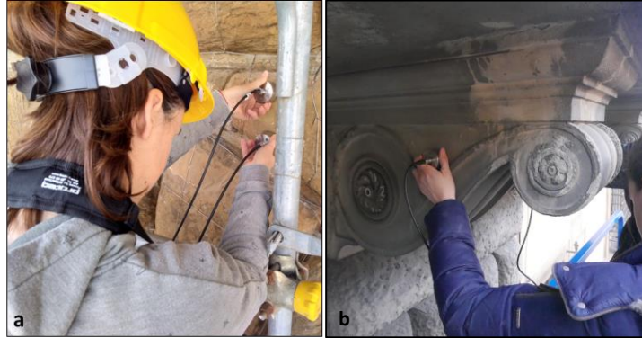
Fig. 1. Strumento ad ultrasuoni IMG 5200 CSD, a e b) indagini ultrasoniche sui bugnati di Palazzo Pitti e mensole di Palazzo Corsini al Prato, c, d, e) indagini soniche sulle murature della Chiesa di San Francesco ai Ferri, Pisa.
