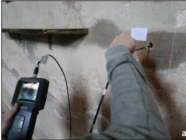
Fig. 4. Strumento utilizzato è un videoendoscopio N308G di Novatest a) indagini soniche sulle murature della Chiesa di San Francesco ai Ferri, Pisa.
