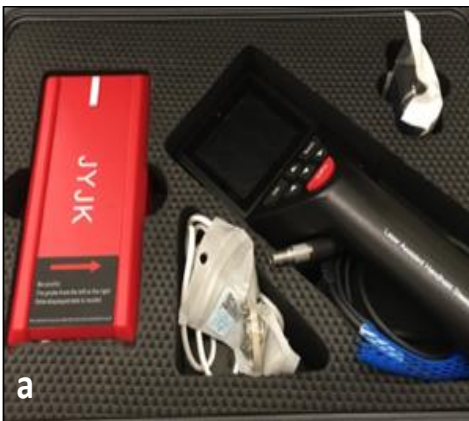
Fig. 6. Pacometro DR3000JY della DRC Diagnostic Research Company a) indagini al Pulpito di Giovanni Pisano, Chiesa di Sant'Andrea, Pistoia, c) indagini a Palazzo Pitti.
