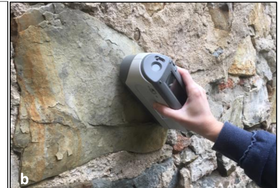
Fig. 5. Spettrofotometro CM-2600d, della Konica Minolta, b) caso applicativo su alterazione Pietra Serena.
