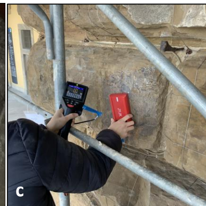
Fig. 6. Pacometro DR3000JY della DRC Diagnostic Research Company a) indagini al Pulpito di Giovanni Pisano, Chiesa di Sant'Andrea, Pistoia, c) indagini a Palazzo Pitti.
