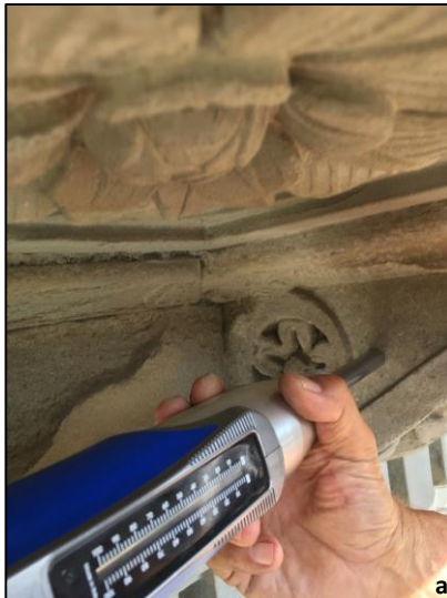
Fig. 3. a) Sclerometro L Geostone della Novatest, b) Sclerometro N.
